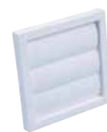
Jalousispjäll Viaduct Ytterväggsgaller med spjällfunktion som förhindrar kalbras när fläkt är i frånslaget läge. Passar i anslutning till Ø100 mm-kanal.
